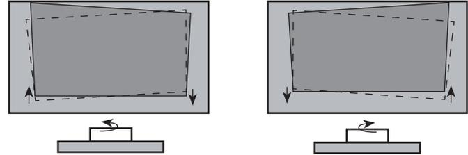
Wenn der untere Bildrand links (bzw. rechts) niedriger und rechts (bzw. links) höher ist, drehen Sie die Konsole gegen den Uhrzeigersinn (bzw. im Uhrzeigersinn), bis der untere Bildrand parallel Leinwand ausgerichtet ist.
