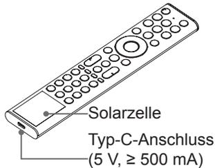
Sie können die Fernbedienung laden, indem Sie die Solarzelle dem Licht aussetzen oder ein USB-Typ-C-Kabel (nicht im Lieferumfang enthalten) verwenden.
